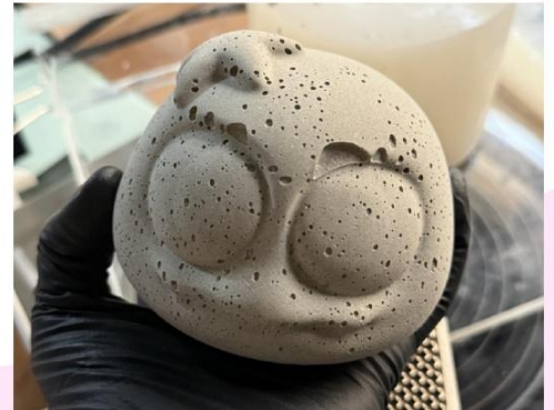
콘크리트 기포 상태 확인
